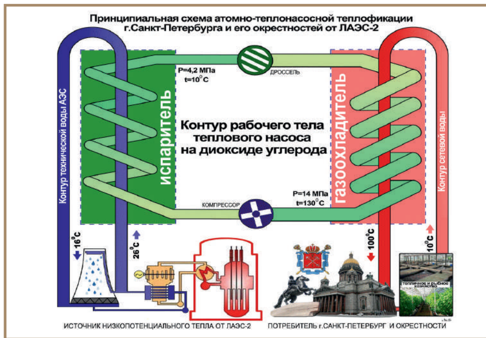
Рис. 10. Схема дальнего атомно-теплонасосного теплоснабжения на примере Санкт-Петербургской агломерации
