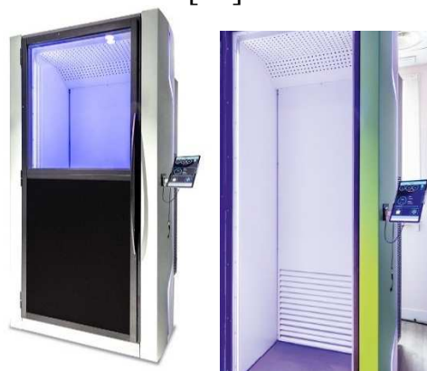
е) Установка компании CryoEco (Франция), индивидуальное ИУ, трехкаскадная холодильная машина (до -110^{\circ}\text{C} , потребляемая мощность 5,5 кВт). [45]
