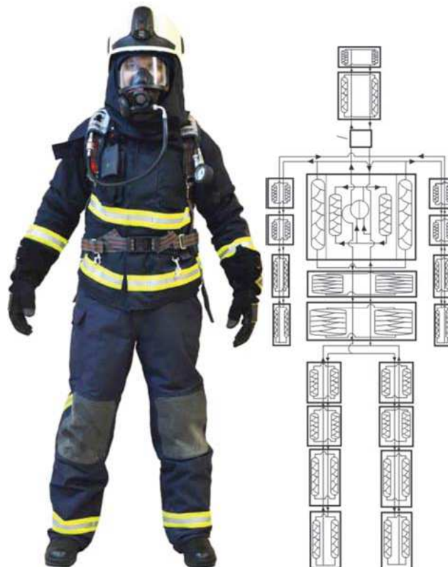
Рисунок 3.9. Защитная экипировка и компартментная модель человека для случая длительного нахождения в окружающей среде высокой температуры [170]
