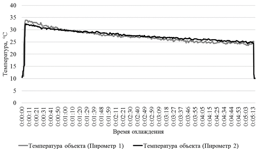
Рисунок 4.18. График охлаждения при температуре -24\text{ }^{\circ}\text{C} при естественной конвекции
