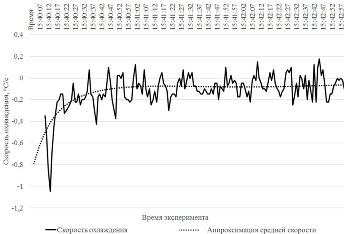
Рисунок 4.19. Изменение средней скорости охлаждения при -24\text{ }^{\circ}\text{C} и скорости обдува (3,5 \pm 0,5)\text{ м/с}
