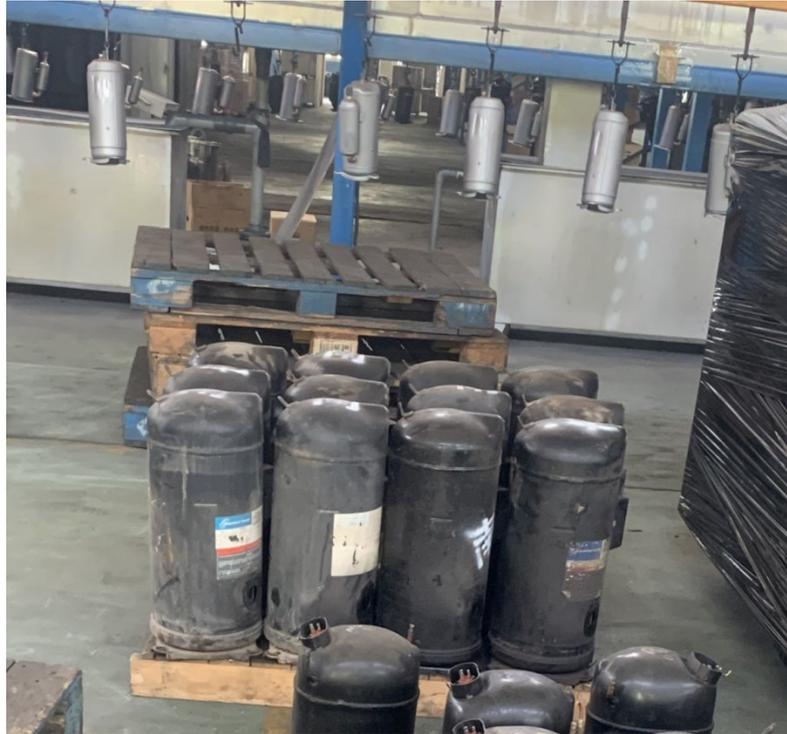
**На фото:** на переднем плане старые, списанные компрессоры Copeland, произведенные в конце 1990х годов, на заднем плане на конвейере - компрессоры едут на покраску.
