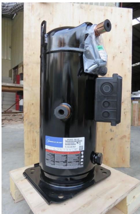
Так выглядит контрафактный компрессор «до» и «после» «реставрации». Внешний вид вполне презентабельный, вот только внутри «начинка», отработавшая свой ресурс с попавшей внутрь грязью и песком, заправленный «левым» маслом!
