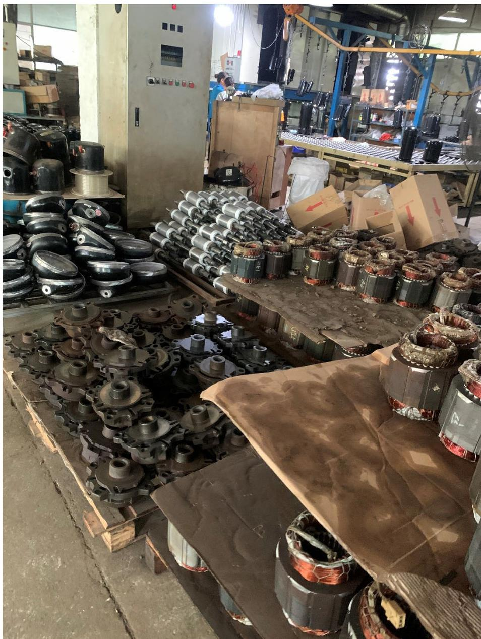
**На фото:** изготовленные кустарным способом сердечники и обмотки электродвигателей, крестовины от б/у компрессоров и срезанные верхние части корпуса компрессоров. На заднем плане линия по покраске. «Гибрид» с неизвестными характеристиками почти готов.
