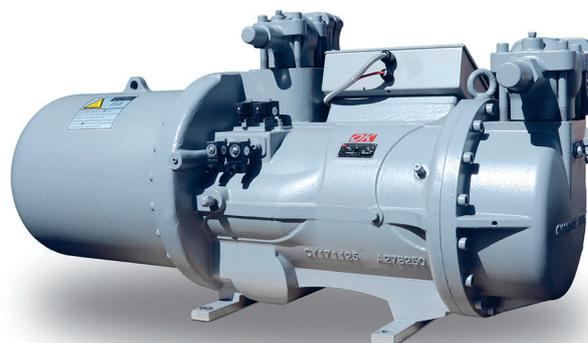
**Серия BSR+.** Это тот же BSR, только для высоких температур кипения хладагента. Предназначен для работы на R134a, позволяет работать в диапазоне температур кипения от +20 до -20°C и диапазоне температур конденсации от +20 до +70°C в режиме с экономайзером. Холодильный коэффициент при этом сопоставим с центробежными компрессорами на паритетных режимах.
