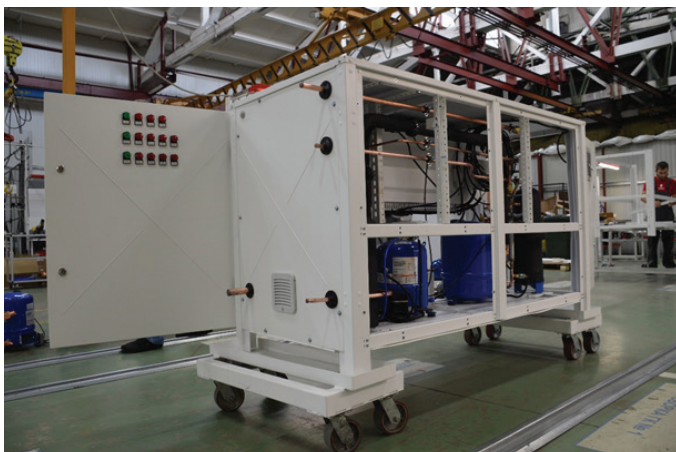
Завод «Элементум», г.Псков. Холодильная машина на финальной стадии сборки
