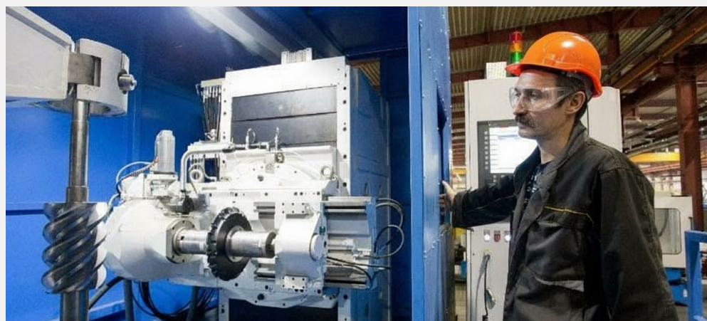
Черновое фрезерование высокоэффективного профиля собственной разработки
