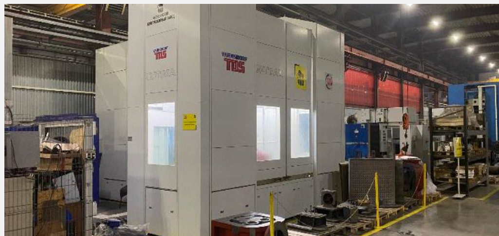
Высокоточная механическая обработка корпусных деталей (4-осевая обработка на обрабатывающем центре с ЧПУ)
